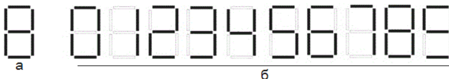
Рис. 1. Семисегментный формат индикатора (а) и цифровые знаки на его основе (б)
